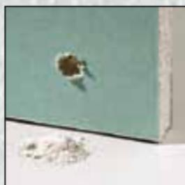
Kod bušenja u gipsane vlaknaste ploče nastane beli vlaknasti prah, a kod bušenja u gips-kartonske ploče fini beli prah koji ostane na svrdlu.
