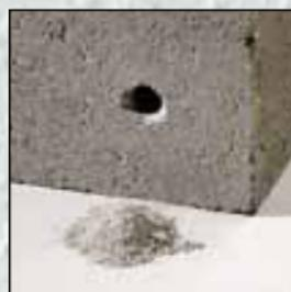
Kod bušenja u beton nastane svetlo sivi do beli prah.
