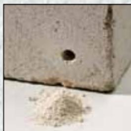
Kod bušenja u vapneni peščenjak nastaje prah peščanog oblika.
