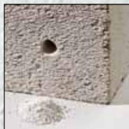
Parobeton – kod bušenja nastane beli, grubo zrnasti i lako razmaziv prah
